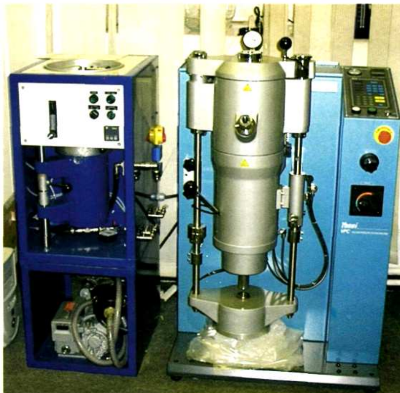
Вакуумные литьевые машины VPC K2-8, Yasui, (Япония) и Starcast M200, Hispana (Испания).
