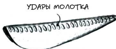
Складка Рюгера - результат «растягивания» складки и проковки края.
